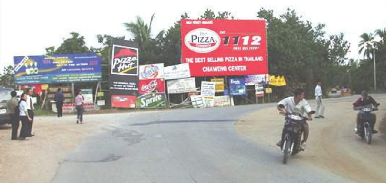
รูปที่ 3.4.1 การยอมให้ติดตั้งโฆษณาในบริเวณทางแยกในรูป นอกจากจะทำให้ผู้ขับขี่ไม่สามารถรับทราบข้อมูลที่จำเป็นในการเข้าใช้ทางแยก เช่น ลักษณะการควบคุมทางแยก ยังเป็นการเพิ่มสิ่งรบกวนสายตา ทำให้ผู้ขับขี่เสียสมาธิในการขับขี่เมื่อเข้าสู่ทางแยก (ที่มา: ยอดพล ธนบุญรัตน์, 2006)
