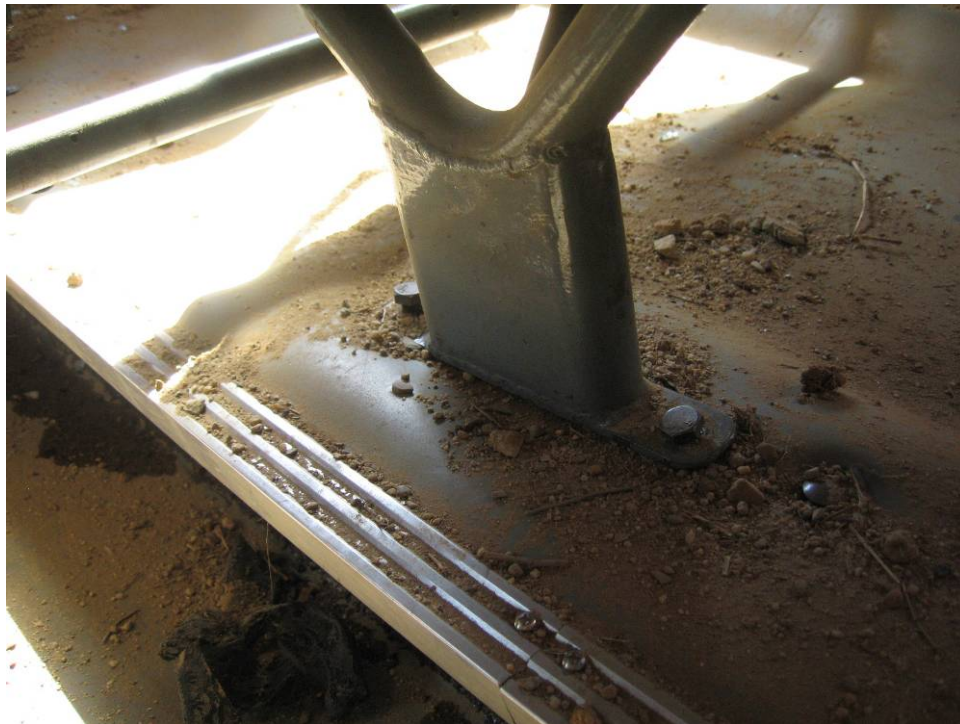
รูปที่ 8 การยึดติดเบาะที่นั่งกับพื้นรถ
