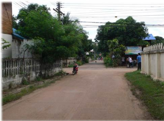
รูปที่ 3.20 ทางแยกที่มีแนวกำแพงและพุ่มไม้บดบังการมองเห็นรถในทิศทางอื่นๆ
