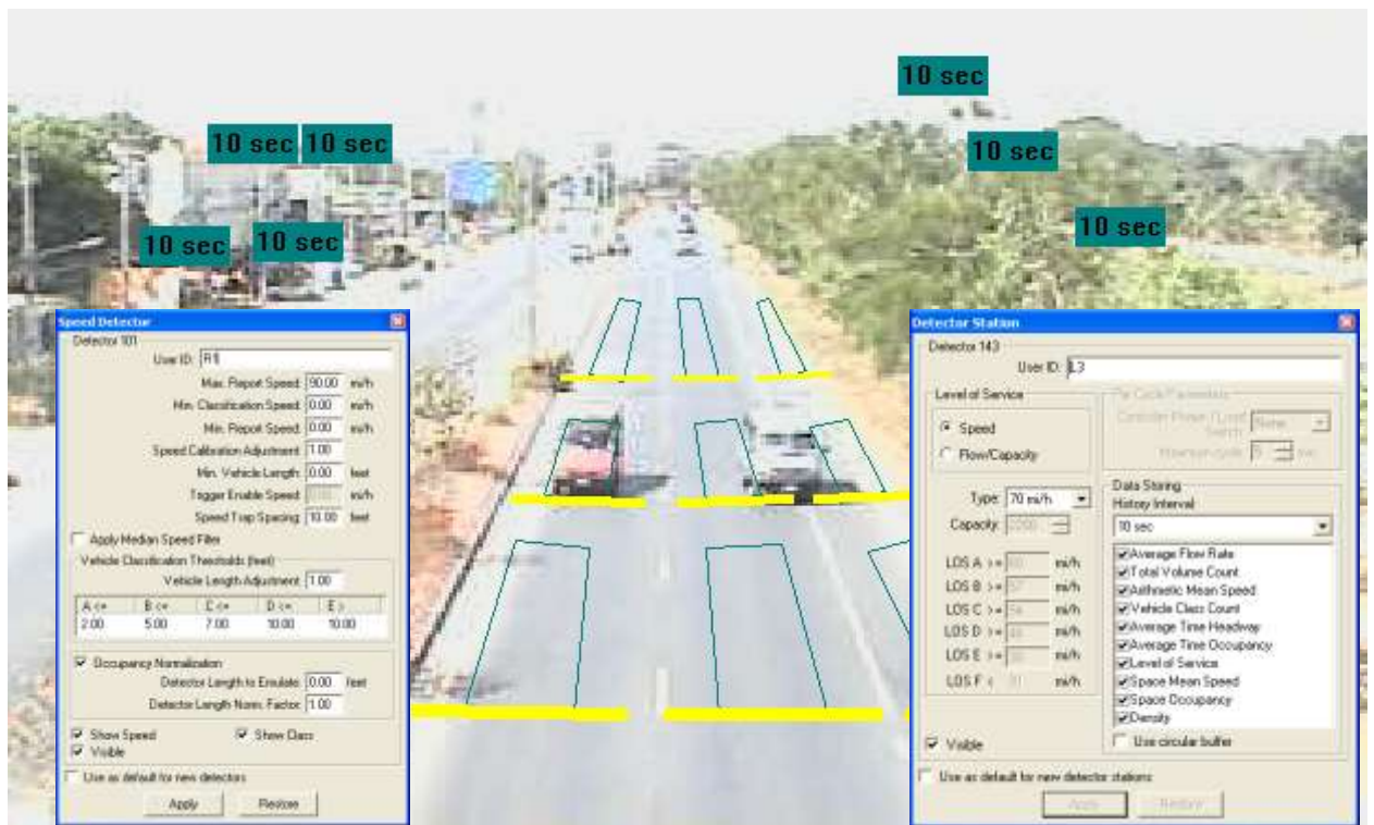
รูปที่ 4.3-3 แสดงการตั้งค่า Detector Station และ Speed Detector
