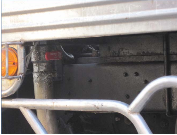
รูปที่ 23 การติดตั้งท่อและวาล์วควบคุมการปิดเปิด
