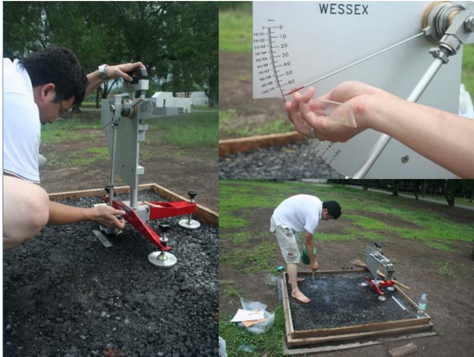
รูปที่ 16 การทดสอบหาค่าความเสียดทานหลังจากการทำความสะอาดผิวทาง
