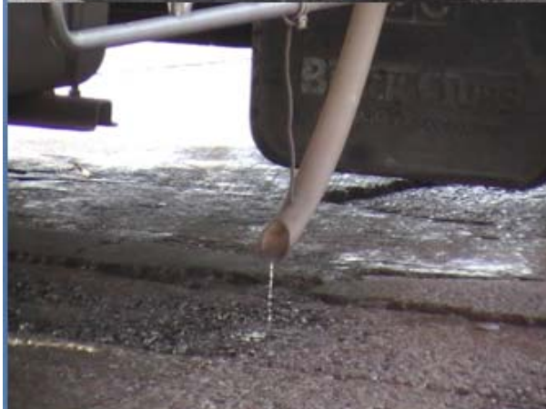
รูปที่ 24 การติดตั้งท่อและวาล์วควบคุมการปิดเปิดแต่ยังมีการปล่อยน้ำเมื่อกปลาลงสู่ผิวถนน
