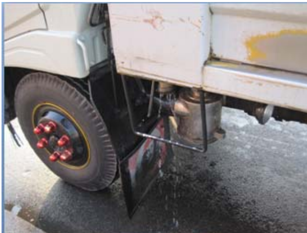
รูปที่ 23 การติดตั้งท่อและวาล์วควบคุมการปิดเปิด
