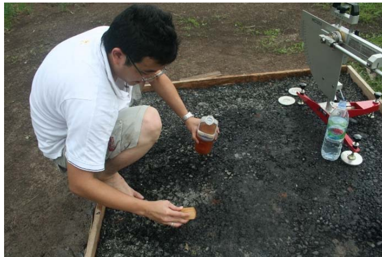
รูปที่ 15 การราดผิวทางด้วยน้ำยาหมักจุลินทรีย์แล้วขัดด้วยแปรงทำความสะอาด
