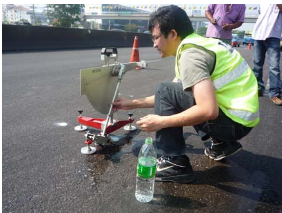
รูปที่ 7 การทดสอบหาค่าความเสียดทางบนถนนพระราม 2
