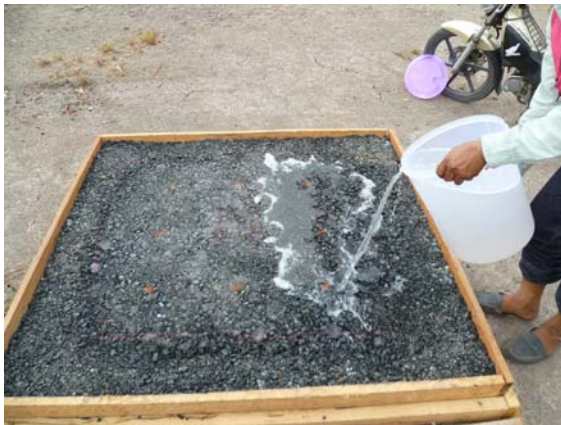
รูปที่ 11 แผ่นจำลองผิวทางที่เตรียมในห้องปฏิบัติการเพื่อทำการจำลองสภาพผิวทางที่ได้รับผลกระทบจากน้ำเมื่อกปลา
