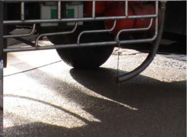
รูปที่ 24 การติดตั้งท่อและวาล์วควบคุมการปิดเปิดแต่ยังมีการปล่อยน้ำเมื่อกปลาลงสู่ผิวถนน
